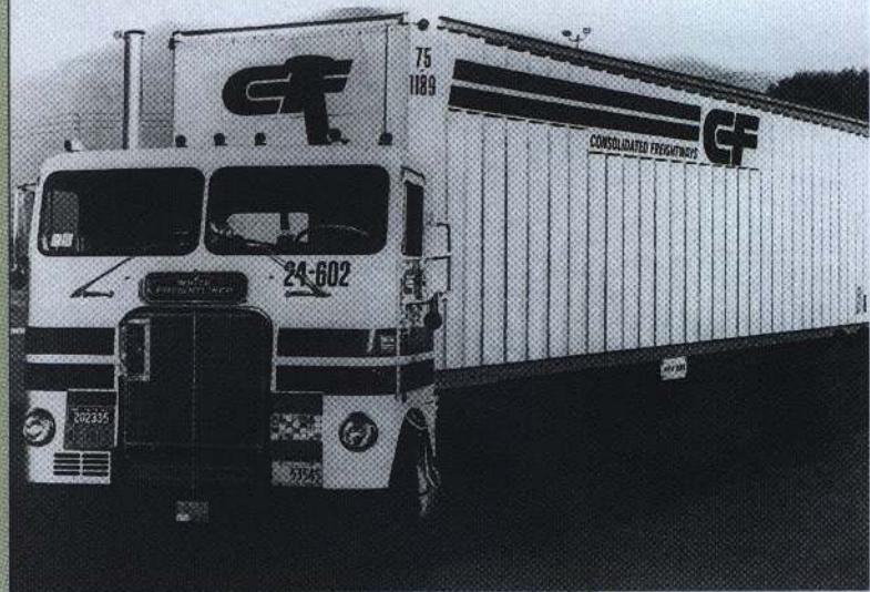
Седельный тягач «Уайт-Фрэйтлайнер» серии 8A-64 с сорокапятифунтовым полуприцепом-фургоном фирмы Frelauf, имеющим двухосную тележку
