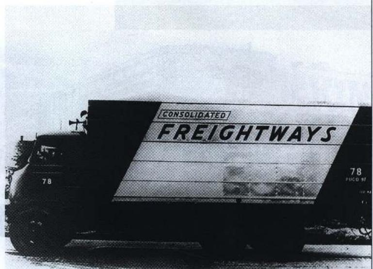
Один из ранних «фрейтлайнеров» 1947 года, на шасси «пинтербита» установлена алюминиевая кабина над двигателем и алюминиевый кузов-фургон
