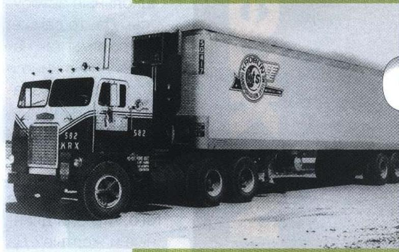
«Уайт-фрейтлайнер» модели WFT-6342-T 1970 года, оборудованный спальной кабиной, с полуприцепом-рефрижератором – был самым распространенным транспортом для перевозки замороженных пищевых продуктов
