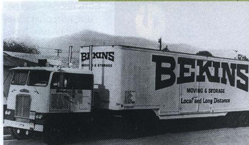
«Уайт-фрейтлайнер» модели WFT-10484-T 1972 года с удлиненным спальным модулем и двухосным алюминиевым прицепом-фургоном для транспортировки мебели, эксплуатировавшийся компанией Bekins
