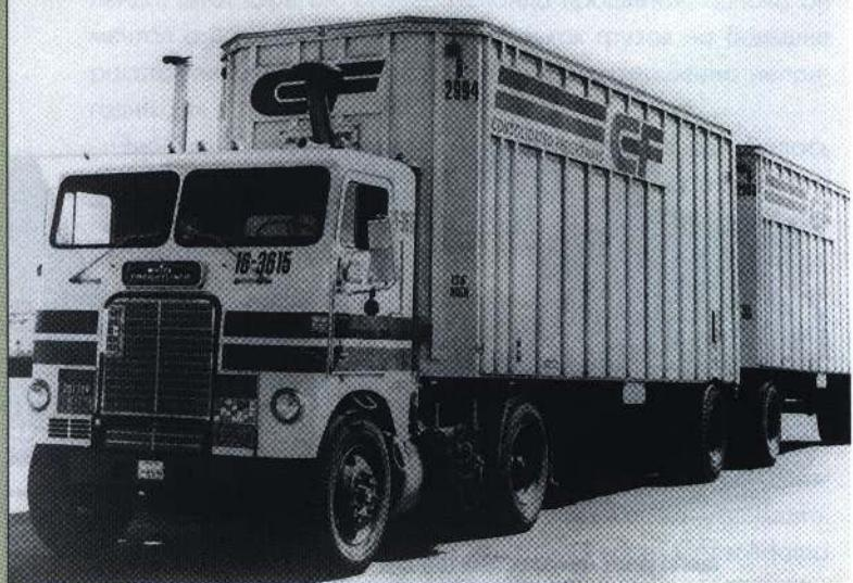
Типичный американский автопоезд шестидесятых: седельный тягач «Уайт-Фрэйтлайнер» серии 8A с алюминиевым полуприцепом-фургоном и двухосным алюминиевым прицепом-фургоном
